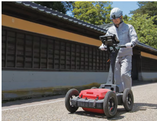
地中レーダー探査による空洞調査
