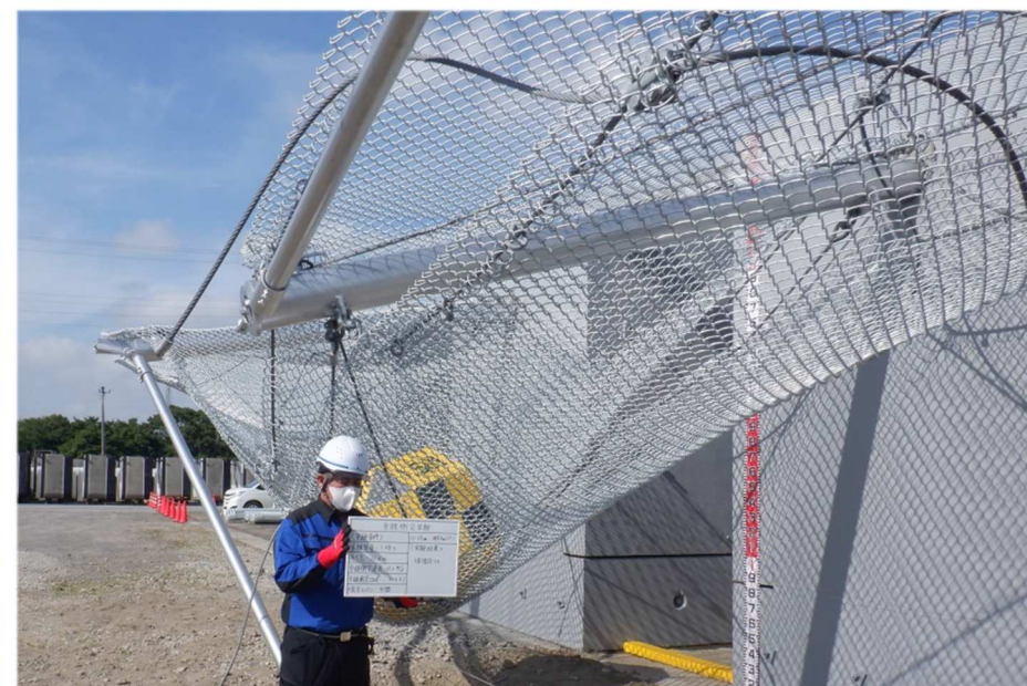
性能確認実験後 (重錘捕捉)
