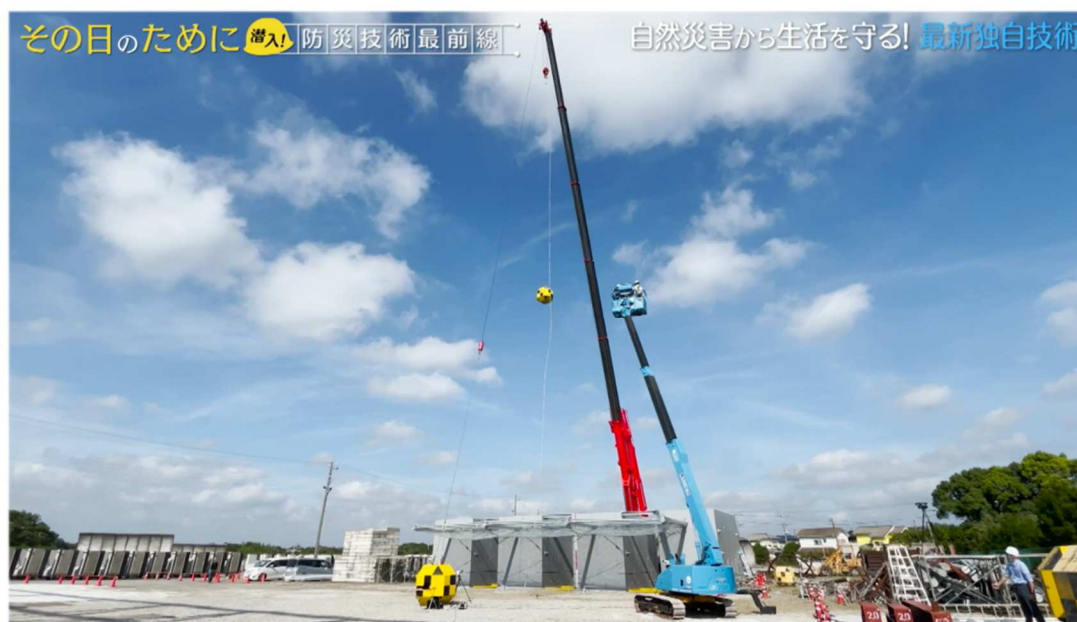
落石防護柵 性能確認実験前 (重錘 1.58t を高さ32.5m から自由落下)
